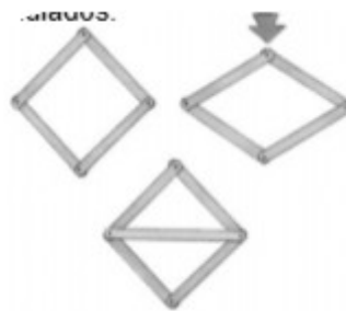
Con la barra formando 2 triángulos, se evita que se deforme el cuadrado
