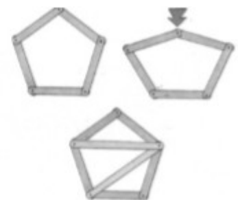
Con la triangulación del pentágono se evita la deformación
